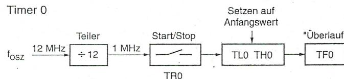
Bei einer Verwendung der Timer als Zeitgeber werden sie vom Systemtakt hochgezählt. Die Periodendauer des Systemtaktes wird über den Zähler addiert. Je nach Anfangswert des Zählers ergibt sich bis zum Überlauf eine bestimmte Zeitverzögerung. Diese Zeitverzögerung ist nicht abhängig vom laufenden Programm. Der Timer läuft, getaktet vom Systemtakt, als eigenständige Hardware-Baugruppe. Die Zeitverzögerung hängt also nur von der Quarzfrequenz ab.
