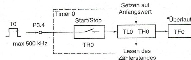
Werden die Timer als Ereigniszähler eingesetzt, erhalten sie ihre Zählimpulse von einem externen Geber. Es werden die negativen Flanken der Eingangsimpulse gezählt. Dabei arbeiten die Zähler unabhängig vom laufenden Programm.
