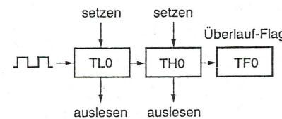
Die Zähler-Register lassen sich auf Anfangswerte setzen. Ab diesen Werten zählen sie nach dem Starten des Zählers aufwärts. Läuft der Zähler über, wird das Überlauf-Flag gesetzt. Nach einem Überlauf lässt sich der Zähler wieder auf einen Anfangswert setzen. Geschieht dies nicht, beginnt er bei dem Wert null.
