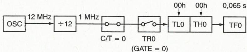
Bei Laden des Timers mit der Zahl 0000h ergibt sich bis zum Überlauf eine Zeit von 0,065 53 s, wenn der Controller mit einem 12-MHz-Quarz arbeitet.
