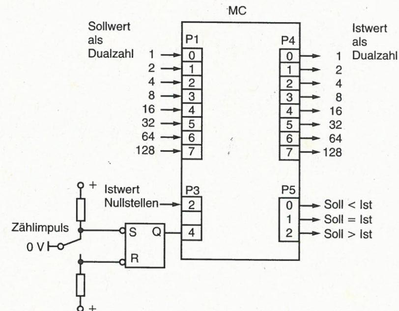
Als Istwertzähler wird Timer 0 als 8-Bit-Reloadzähler eingesetzt. Der Reloadwert ist die Zahl 00h. Der Timer zählt die an P3.4 eintreffenden Impulse unabhängig vom laufenden Programm. Der Istwert des Timers wird vom laufenden Programm gelesen und bearbeitet.
