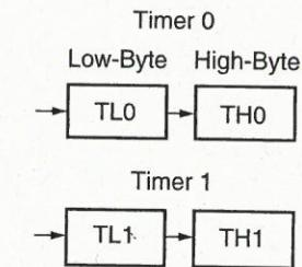
Die Zähler-Register lassen sich auf Anfangswerte setzen. Ab diesen Werten zählen sie nach dem Starten des Zählers aufwärts. Läuft der Zähler über, wird das Überlauf-Flag gesetzt. Nach einem Überlauf lässt sich der Zähler wieder auf einen Anfangswert setzen. Geschieht dies nicht, beginnt er bei dem Wert null.
