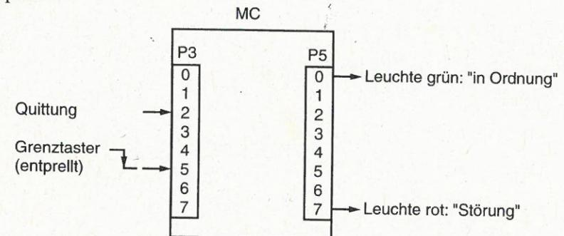
Als Zeitgeber wird Timer 0 verwendet. Die Basiszeit bis zum Überlauf beträgt 0,065 s. Die Überläufe sind zu zählen. Hat der Überlaufzähler die Zahl 77 erreicht, sind ca. 5 s vergangen. Als Ereigniszähler wird Timer 1 eingesetzt. Hat der Ereigniszähler innerhalb 5 s mehr als drei Grenztaster-Betätigungen gezählt, liegt eine Störung vor, die angezeigt wird.
